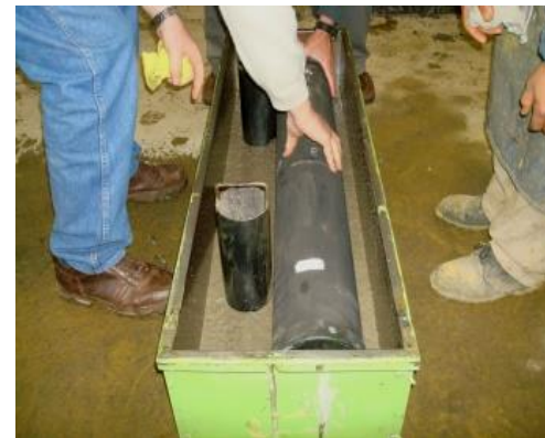
Molde y hormigonado (Hº + Agua)
