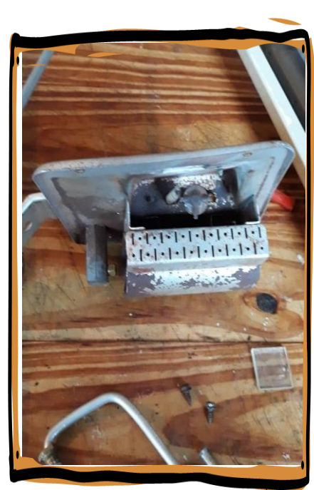
Detalle de quemador de 3000 Kcal/hora
