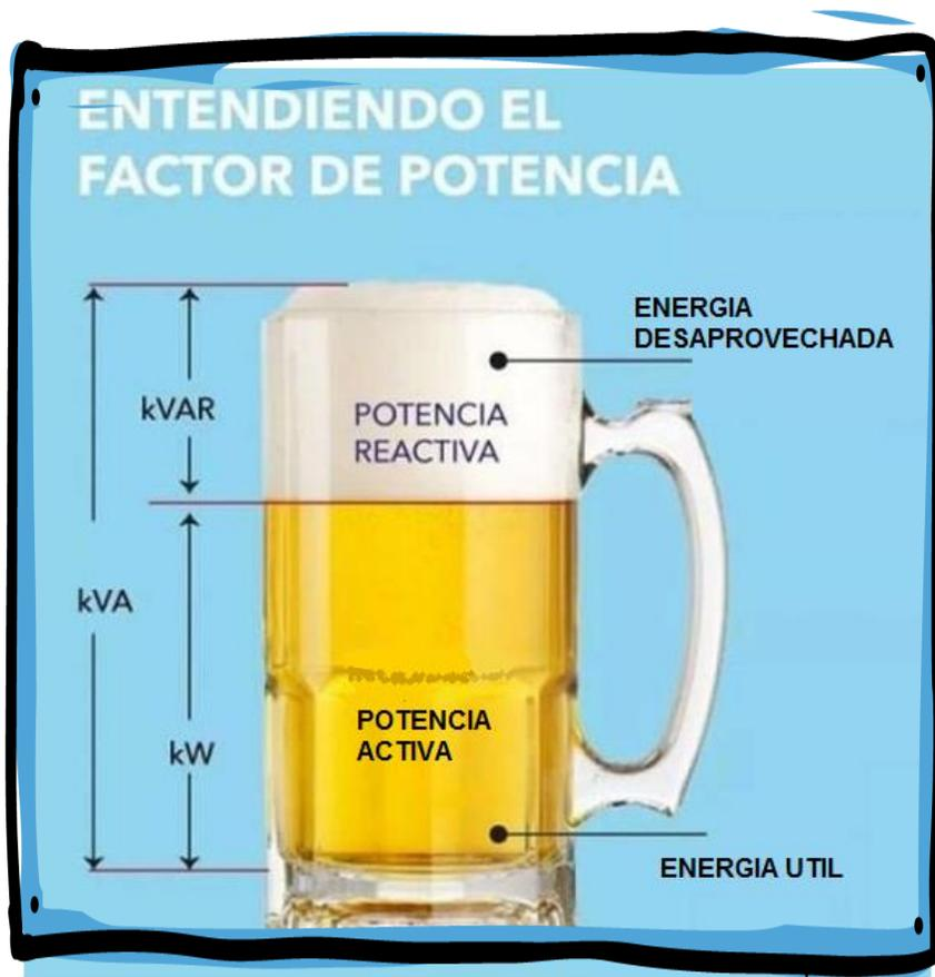
El total del vaso es la **POTENCIA APARENTE**, conformada por la **POTENCIA ACTIVA** y la **POTENCIA REACTIVA**.
